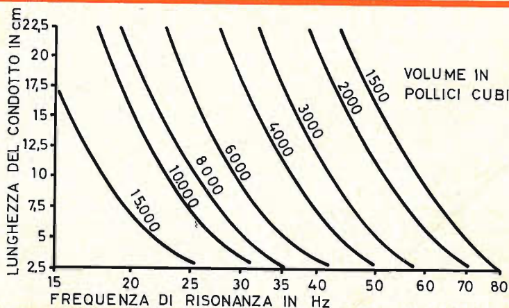
Fig. 7 - Nomogramma per calcolare la lunghezza del condotto adottando per lo stesso un diametro di 7,5 centimetri.
