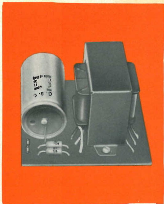
Fig. 3 - Aspetto dell'alimentatore UK 610 a montaggio ultimato.
